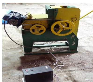
شکل ۱- ماشین جین اره‌ای به همراه اینورتر (سمت راست)، وش پنبه در حال فرآوری با اره (سمت چپ)
