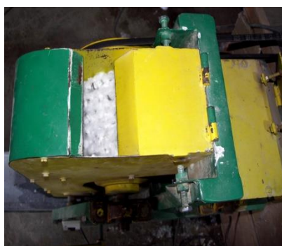
شکل ۱- ماشین جین اره‌ای به همراه اینورتر (سمت راست)، وش پنبه در حال فرآوری با اره (سمت چپ)
